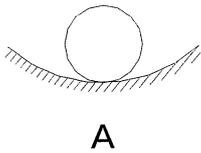
La figura A corresponde a un caso de **equilibrio estable**, el cilindro se encuentra en la posición de mínima energía potencial, cualquier desplazamiento genera fuerzas que tienden a restituir la posición inicial.
