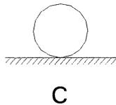
La figura C corresponde a una situación de **equilibrio indiferente**, un desplazamiento del cilindro no provoca ni fuerzas que tienden a devolverlo a la posición primitiva ni que amplifiquen el movimiento.
